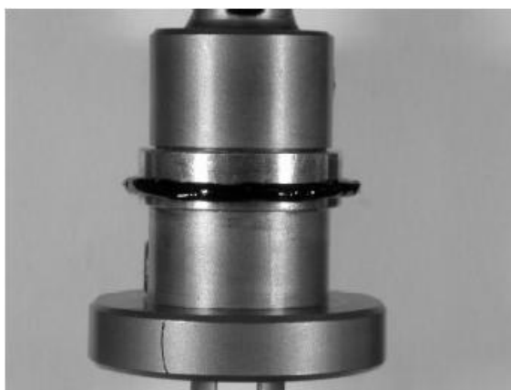
Figura 750D - 5. Saliente excesiva
