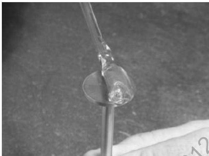
Figura 750C - 1. Usando una varilla de vidrio para colocar el fluido de referencia en el plato
